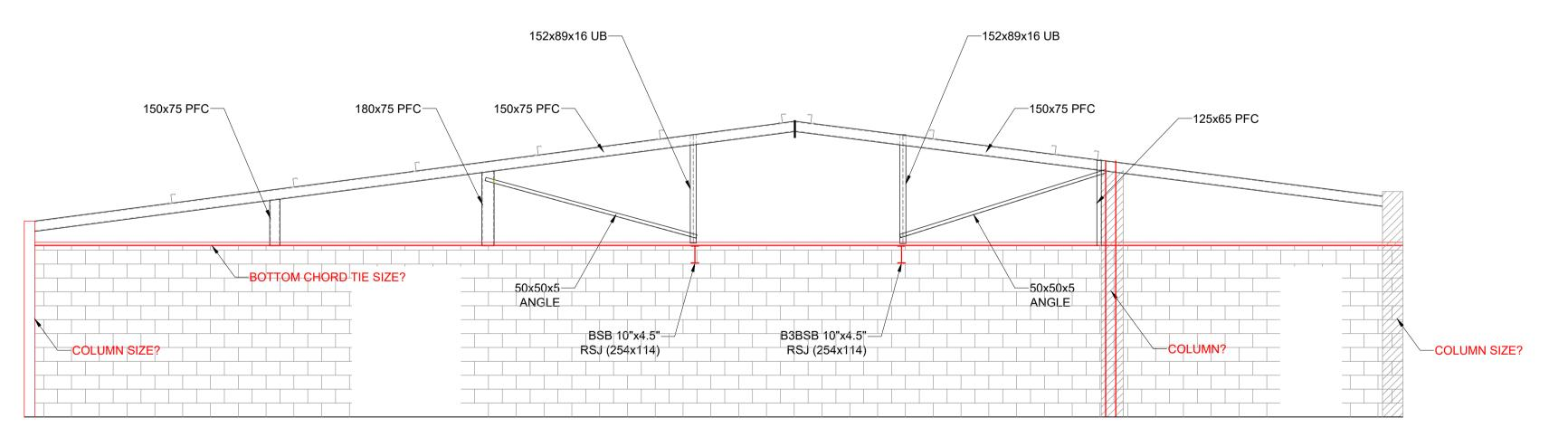
SECTION 3 - TRUSS 3 SCALE: 1:50 A1
