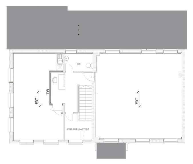
**ERT - EXISTING ROOF TRUSS**
