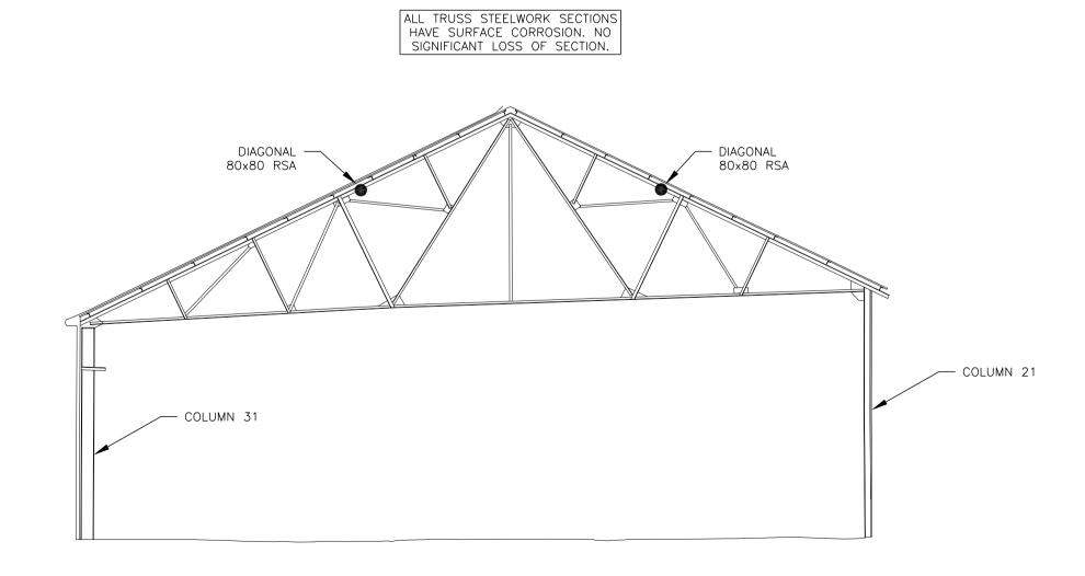
TRUSS MEMBER SIZES AS TRUSS '1', SPAN 'C'.
