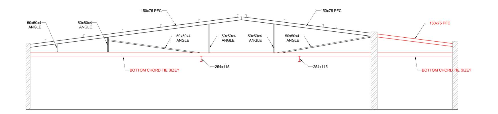
SECTION 12 - TRUSS 12 SCALE: 1:50 A1
